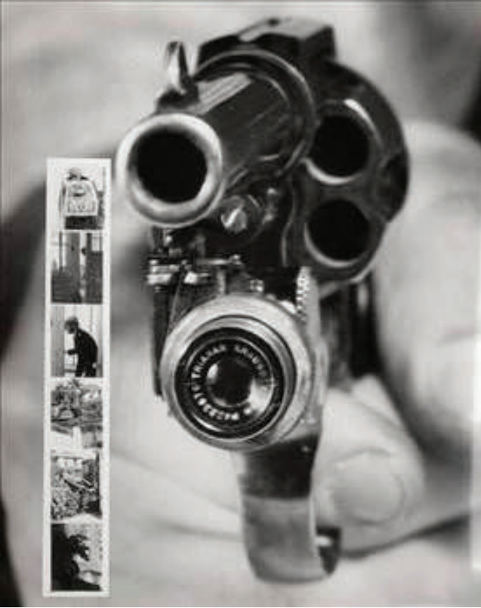
38'lik Colt tabancaya monte edilen bu kamera, tetiğe her bastığınızda fotoğraf çekiyordu. Soldaki küçük karelerde çekilen fotoğrafları görebilirsiniz.
